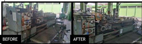
車床加裝透明防護罩防止切削屑噴濺
