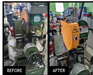
切割機加裝金屬防護罩避免切割片破裂時噴濺
