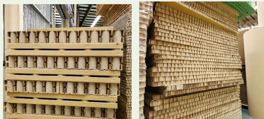
工廠原使用塑膠棧板，考量塑膠棧板損毀後不易修補，每月平均報廢5~10片，增加廢棄物產生量，故工廠投入研發，將廠內廢紙箱、紙管再製成紙棧板，乘載強度一致，且壽命至少可達2~3年，倘若損毀亦可回收再製成原紙，達成循環經濟之效益。
